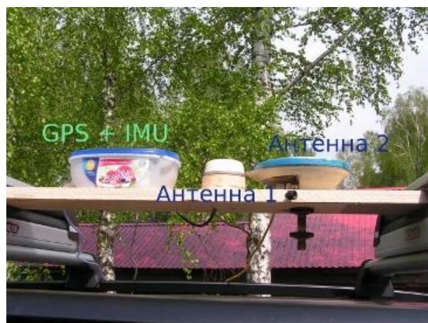
. Комплекс GPS+IMU, одночастотная антенна и двухчастотная антенна на крыше автомобиля
