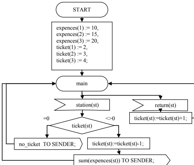
Рис. 7. Блок-схема процесса main-machine
