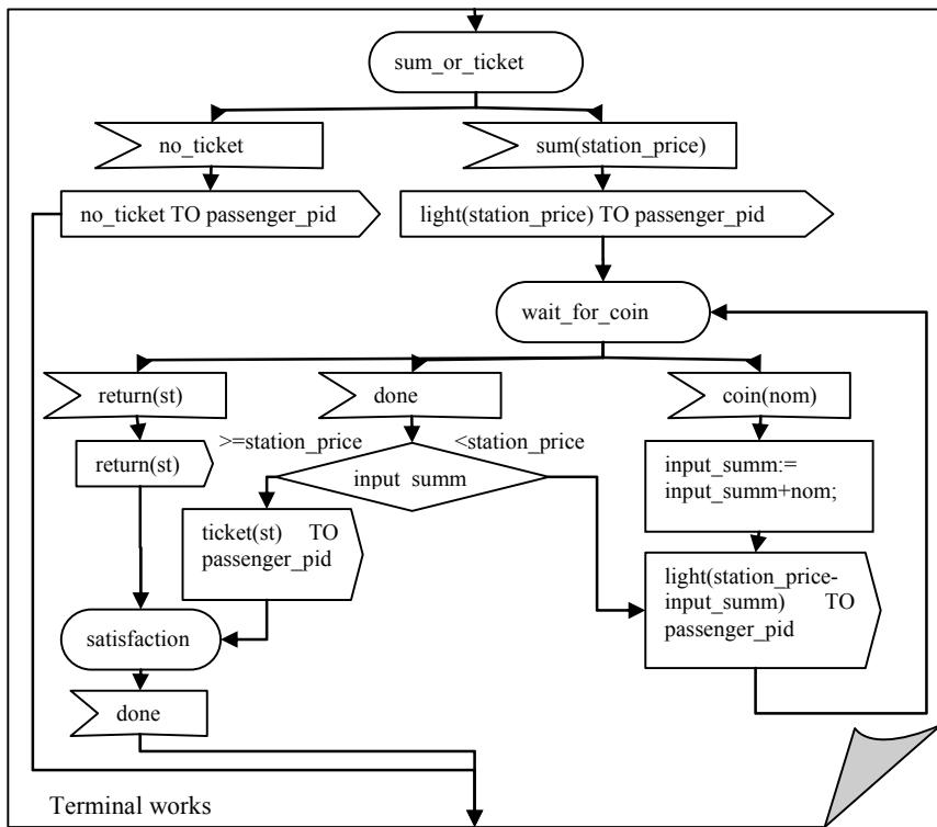
Рис. 9.2. Блок-схема фрагмента процесса terminal
