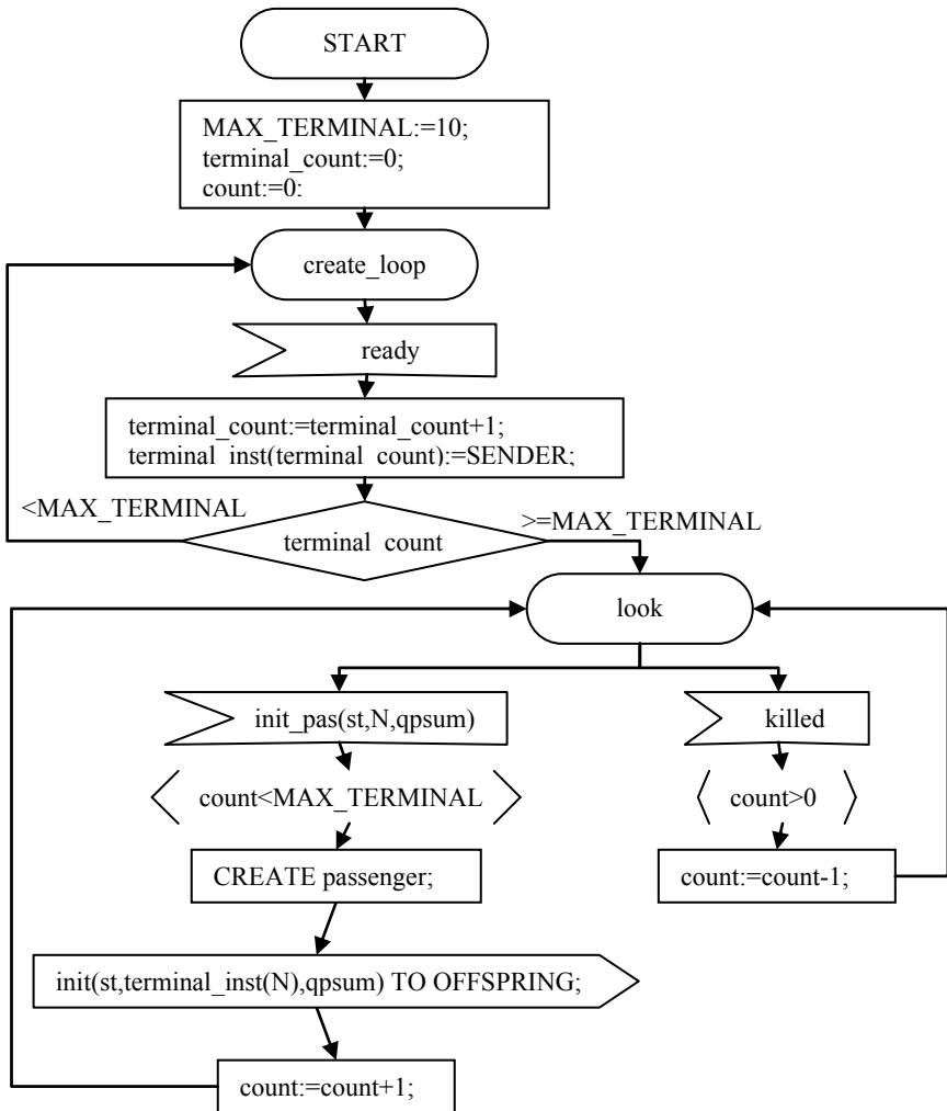
Рис.6. Блок-схема процесса queue
