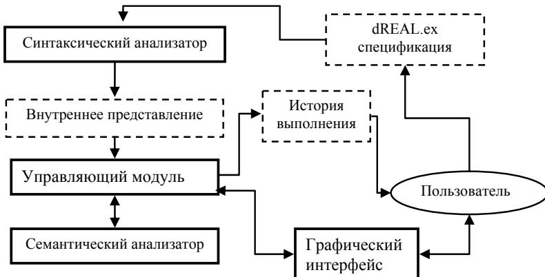
Рис. 2. Структура системы симуляции выполнимых dREAL-спецификаций
