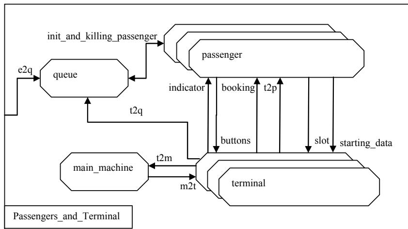
Рис.5. Блок-схема системы управления сетью касс-терминалов
