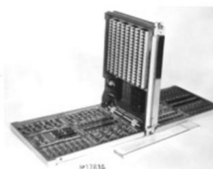
Рис. 12.2 Блок ПЗУ. «Гном1-66»
