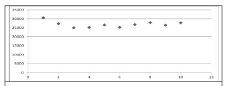
Puc. 1. Зависимость времени в миллисекундах от количества работающих потоков при использовании библиотеки Concurrent. Thread
