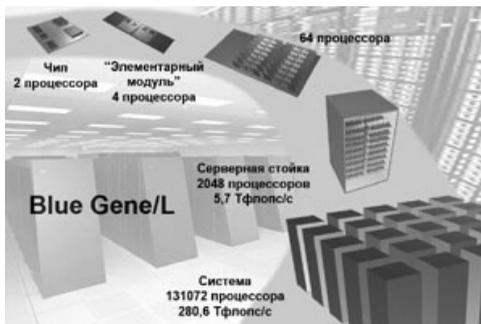
блоками строится трехмерная тороидальная сеть; для выполнения общих операций – «сеть-дерево», а также присутствует сеть барьеров и прерываний, общая для всей системы. Все устройство вычислительной системы довольно компактно (в сравнении с конкурентами) и экономично. Разработчики создали хорошую систему охлаждения, состоящую из радиаторов с наклонными ребрами, благодаря которым охлажденный воздух распределяется более рационально.
