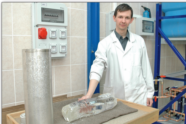
Первый самостоятельно выращенный крупногабаритный кристалл германата висмута. И. А. Томас. 2006 г. 385
