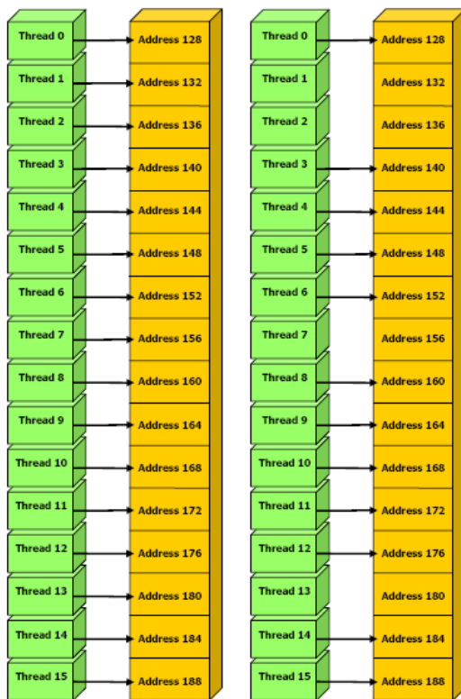
Рисунок 10 Левая колонка: объединенный float доступ к памяти, результат 1 транзакция. Правая колонка: объединенный float доступ к памяти (расходящиеся потоки), результат 1 транзакция.
